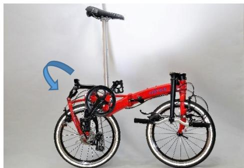
5:フレーム中央部の折り畳みレバーを解除し、左手でヘッド部を持ちあげつつ左に180度折りたたむ。この時、前後についている固定マグネットをしっかりと吸着させてください。
