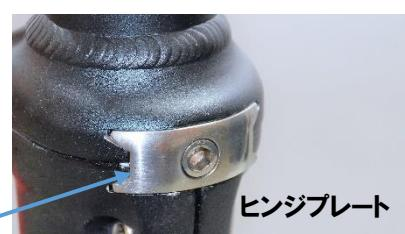
ロック機構は折りたたみレバーが外部からの衝撃等でふいに緩んでしまうのを防ぐための安全装置です。自動ロック機構を備えたモデル以外は、ヒンジ部を固定した後に必ずロックをかけてください。
