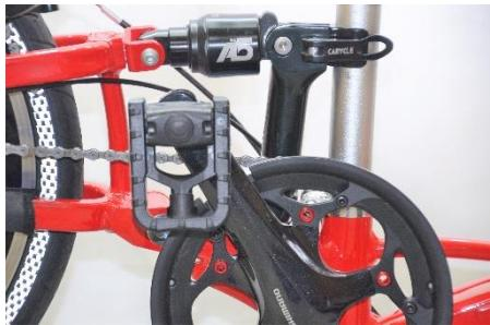
2:フロントフォークを右に 180 度回し、折りたたみハンドルポストのロックを外し、ヒンジレバーを緩め折り畳みハンドルポストを折りたたむ。
